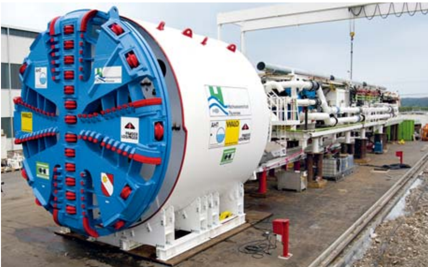
Abbildung 9b Ansicht von vorne gegen das Schneidrad, daran anschliessend weiss gestrichen der Schild und dahinter Teile des Nachläufers (unter Kran), welcher die Installationen für die Maschine und den Rohausbau des Tunnels enthält.
